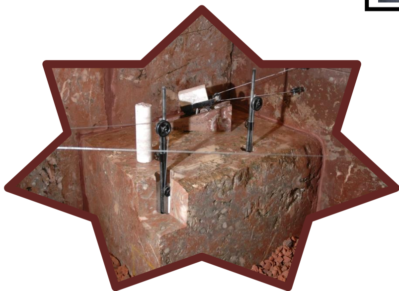
Maquette – extraction au fil hélicoïdal – Musée du marbre
