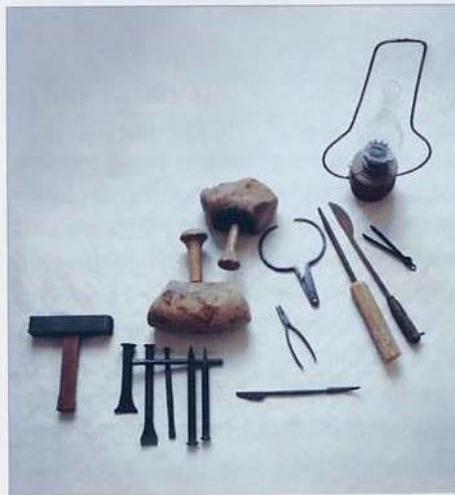
L'équipement du marbrier : les maillets, la lampe à pétrole, le compas, le fer à mastiquer, les pinces, la boucharde, les ciseaux, ciselets, diales et pointes.
