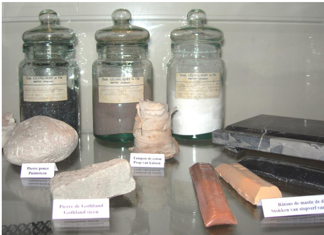
Les outils de la polisseuse : pierre ponce, pierre de Gothland, tampon de coton, bâtons de mastic de couleurs différentes, et diverses préparations dans les bocaux en verre
