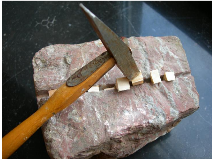
Reproduction en miniature de l'extraction à l'aide de coins frappés par une masse
